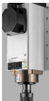
Motore mandrino da 3 o 4KW con attacco pinze ER25 24000rpm gestiti da inverter.
