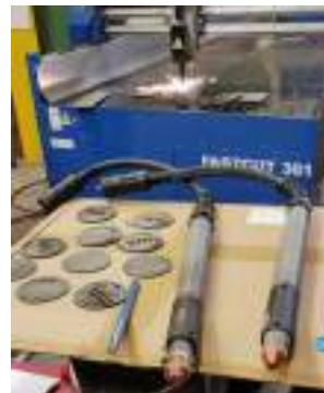
**Per una rapida sostituzione della torcia, nel caso di danneggiamento della stessa, oppure per migliorare la qualità di taglio, utilizziamo torcini con connessione rapida.**
