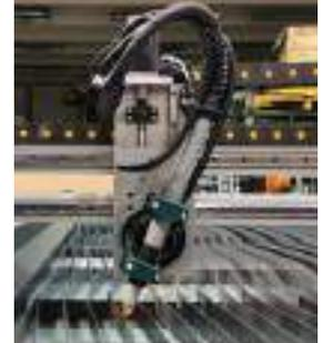
**Il supporto di rotazione torcia, permette di impostare manualmente l'inclinazione della torcia ed eseguire un taglio inclinato**
