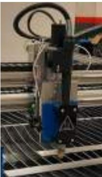
**Anticollisione torcia, previene il danneggiamento della torcia, nel caso di impatto con sfridi o errata programmazione, bloccando tempestivamente la macchina**
