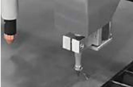
**Utensile pneumatico e vibrante automatico, per la marcatura dei metalli. Adatto per segnare la numerazione delle piastre, o gestire le linee di piega.**
