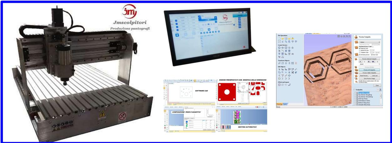
**Pantografo cnc professionale, completo di software per lavorazioni 3D. Questa macchina estremamente rigida, permetta lavorazioni precise e rapide, grazie a movimenti su guide a ricircolo di sfere a gioco zero e motori con gestione encoder.**
